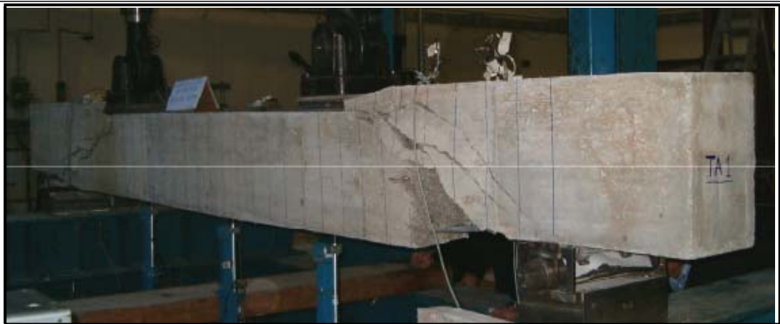
Deformata della trave al termine della prova
