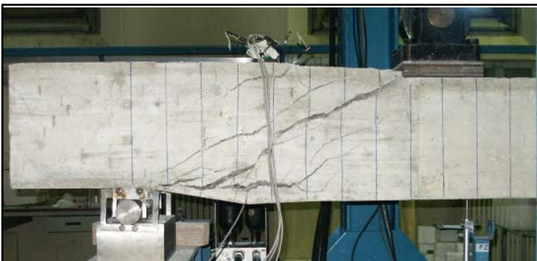
Fessurazione nella trave al termine della prova
